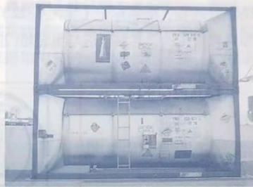
图 7-19 登箱顶触电警告标记在罐式集装箱上的位置
